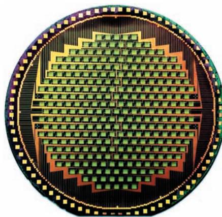
Pole 295 bolometrických snímačů použité v kameře LABOCA. Průměr křemikové destičky je 102 mm. MPIfR.
