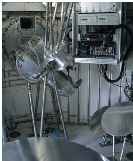
Detekční část zařízení LABOCA v Cassegrainově ohnisku radioteleskopu. Stříbřité talíře ve spodní části snímku jsou odrazná zrcadla směřující optický svazek přicházející z primární antény do detektoru. Detektor sestávající z 295 bolometrů je ukryt ve stříbřitém válci (kryostatu), který je umístěn uprostřed.
