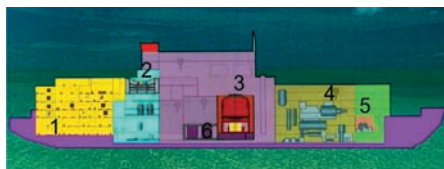
Průřez elektrárnou. 1. Obytná zóna, 2. Operační místnost, 3. Reaktory, 4. Parní turbíny, 5. Zóna vytváření energie, 6. Zóna pro uskladnění jaderného odpadu.
