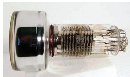
Fotonásobič. Na levé straně je fotocitlivá katoda emitující elektrony, jejichž počet roste v jedenáctistupňovém násobiči na pravé straně. National Valve Museum.
