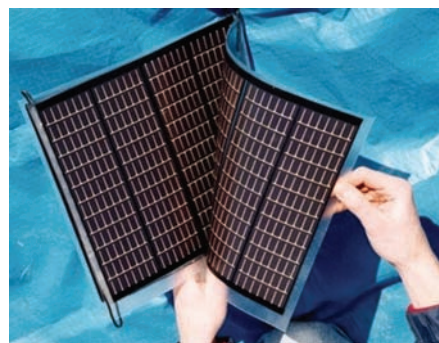
Články z organických polymerů mají úžasné mechanické vlastnosti, které je předurčují k použití v mobilních zařízeních. Kim a kol., Science AAAS, Science Magazine, 2007.
