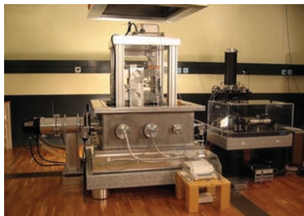
Realizace experimentu Watt Balance ve švýcarském Národním metrologickém ústavu (METAS) v Bernu.
