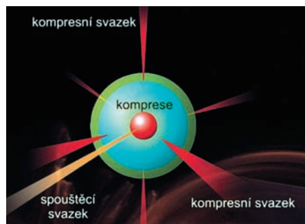
Princip laserem řízené fúze.
