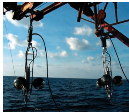
Pokládání struny se třemi optickými moduly z lodi.
