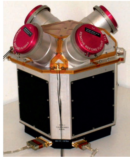
Čtveřice koloidních trysek pro jemnou navigaci sondy LISA Pathfinder. Zdroj: ESA.
