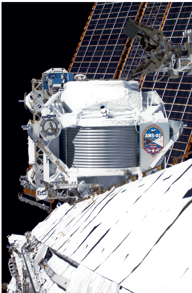
Obr. 6: Částicový detektor AMS 2 umístěný na rameni Mezinárodní kosmické stanice. Detektor analyzuje částice kosmického záření, které k nám přicházejí z blízkého i vzdáleného vesmíru. Zdroj: NASA.
