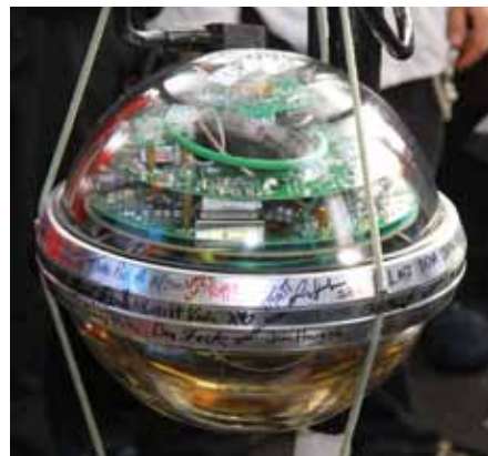
Digitální optický modul DOM. Ve spodní polokouli je umístěn fotonásobič, v horní zdroj a kalibrační LED dioda. Zdroj: IceCube.
