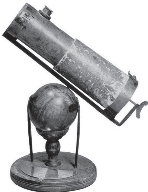
První Newtonem zkonstruovaný zrcadlový dalekohled. Dřevěný tubus sestává ze dvou do sebe zasunovatelných dílů. Na horním konci vyčnívá kolmo na optickou osu okulár.
