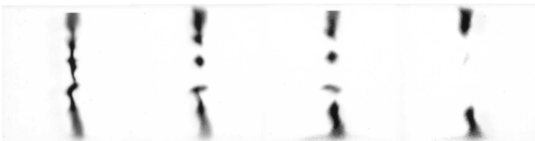
Obr.4.5: Kulová struktura po emisi rentgenového pulsu
