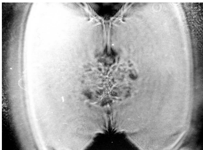
Obr.4.1: Šlířová fotografie turbulencí v magnetickém pinči
