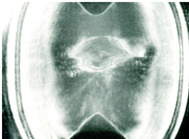
Obr.4.6: Plazmoid v argonové náplni
